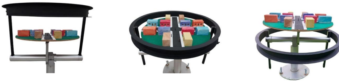
Figura 8. Trayectoria del sol en los polos (latitud 90^\circ ) para los solsticios y equinoccios: (izq) Solsticio de verano, (centro) Equinoccios de primavera y otoño, (der) Solsticio de invierno.
